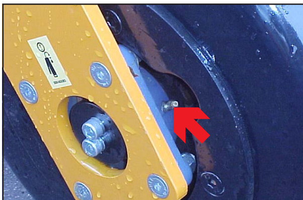
Fig. 5.08: DD Light Roll Grease Points
